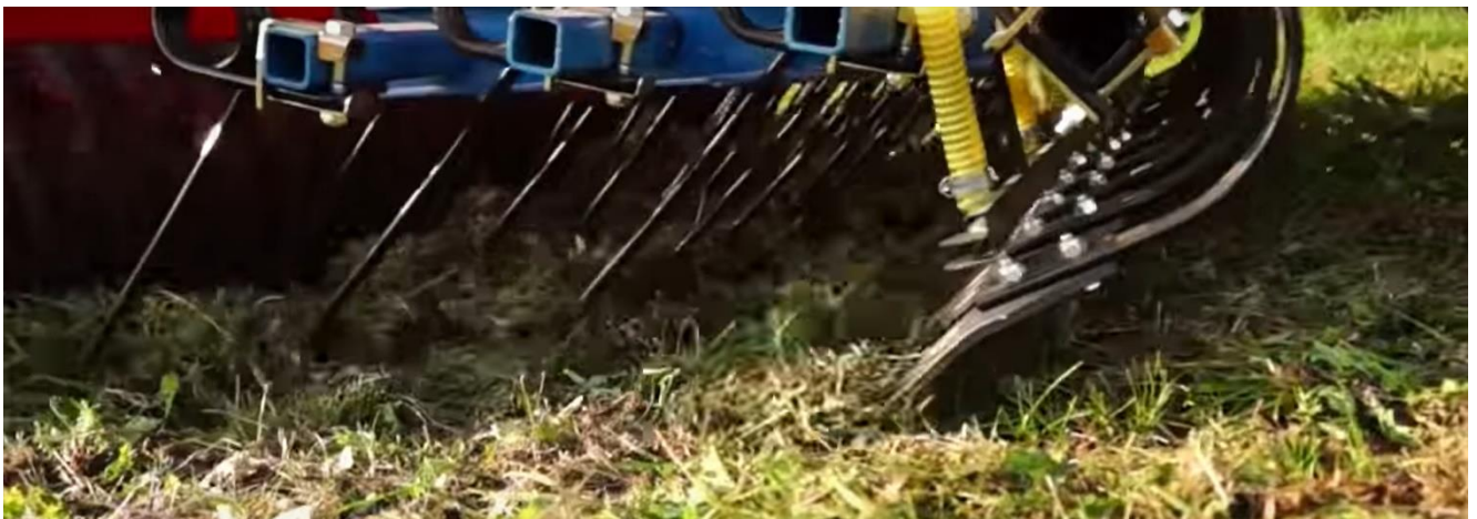
Nachsaat mit Streifblechen, Striegel und Walze (Quelle: hatzenbichler.com)
