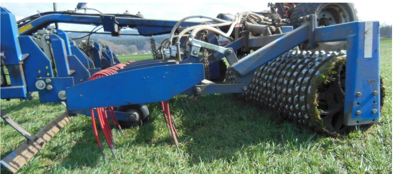
Nachsaat mit Streifblechen, Striegel und Walze (Quelle: hatzenbichler.com)
