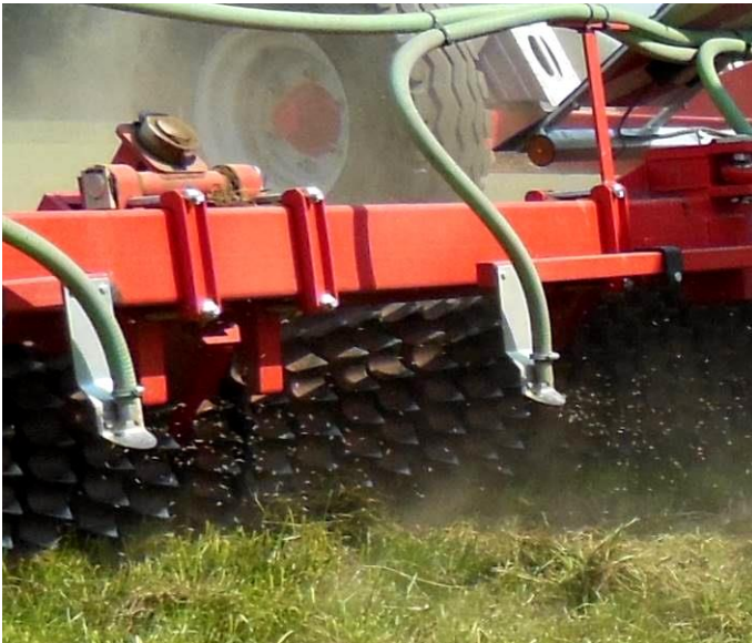
Saatgut gleich anwalzen sorgt für Bodenschluss
